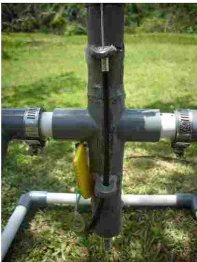
Lubangi bagian kaitan PVC kabel rem. Pada kaitan PVC bagian atas, lubang yang dibuat seukuran dengan kawat yang berada di dalam kabel rem, sedangkan pada kaitan PVC bagian bawah, lubang dibuat seukuran dengan kabel rem. Kaitan PVC bagian atas berfungsi menahan kabel rem saat *handle* rem ditekan. Kabel rem yang tertahan menyebabkan kawat yang berada di dalam kabel rem akan tertarik
