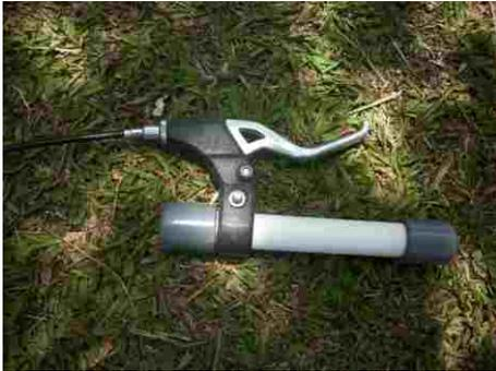
Pasang *handle* rem pada pipa PVC ukuran ½". Kencangkan bagian baut penguncinya agar *handle* rem terpasang dengan erat pada pipa PVC ukuran ½". Tambahkan dop PVC ukuran ½" pada kedua ujung pipa. Pasang kabel rem pada *handle* rem. *Handle* rem yang digunakan bisa *handle* rem stang kanan atau kiri. Hal ini tidak masalah mengingat fungsi *handle* rem ini hanya sebagai alat pelepas roket dari peluncurnya.
