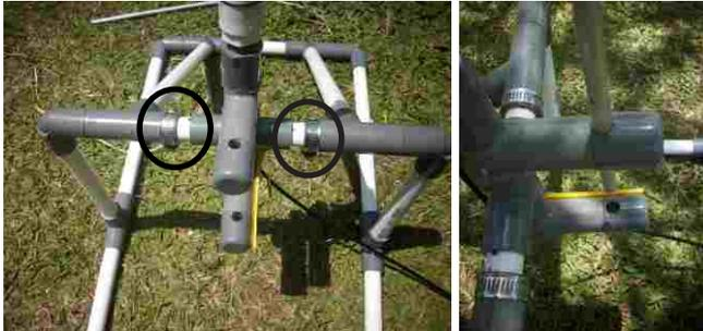
memasukkan pipa PVC ukuran ½” yang telah dilem pada pipa-utama peluncur. Beri klem besi ukuran 1 1/4” pada bagian Tee PVC dan kencangkan secukupnya (gambar kiri atas pada bagian dalam lingkaran hitam).
