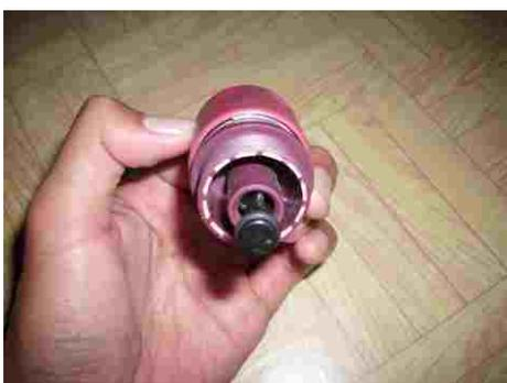
Pada bagian dalam *Hose Quick Connector*, beri lem epoksi yang telah dicampur dengan kuantitas banyak. Pastikan bagian *stopper* udara (air) tidak terkena lem jika *stopper* ini tidak dilepas. Pasang pipa PVC ukuran ½“ ke dalam bagian *Hose Quick Connector* yang telah diberi lem epoksi. Beri tekanan sampai pipa tidak bisa terdorong masuk lagi.
