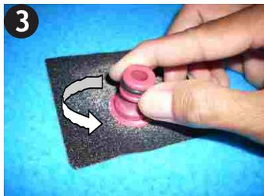
Gunakan amplas kasar untuk menipiskan bagian bawah *Quick Tap Adapter* dengan pola amplasan memutar.
