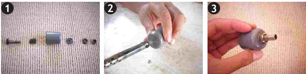
Gambar kiri atas merupakan konfigurasi pemasangan dop-bunglon. Istilah "bunglon" penulis dapatkan dari Bpk. Endjang Patriatna. Bunglon mudah didapatkan di tukang tambal ban.
