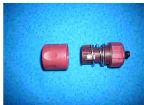
Patahkan bagian plastik yang menyerupai kipas pada *Hose Quick Connector*. Bagian ini berfungsi menahan selang. Setelah itu, amplas bagian kepala *Hose Quick Connector* seperti yang terlihat pada gambar di samping. Pengamplasan jangan sampai menghabiskan bagian yang berfungsi menghambat pergerakan penutup *Hose Quick Connector*. Amplas sampai dengan ketebalan sekitar 0,5 mm.
