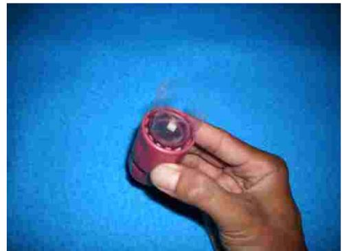
Setelah plastik terselip dengan benar, dorong bagian badan *Hose Quick Connector* dengan menggunakan tangan.
