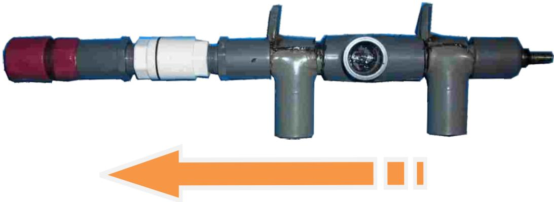
Susunan lengkap pipa-utama peluncur. Penulis menamakan bagian ini sebagai pipa-utama peluncur karena aliran udara yang merupakan sumber utama tenaga pendorong roket hanya mengalir pada pipa ini mulai dari bunglon bergerak lurus ke arah kepala peluncur (mengikuti tanda panah merah).
