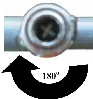
Pipa-utama peluncur dilihat dari atas. TEE PVC yang dipasang sebagai pemegang pipa-utama peluncur tetap sejajar membentuk sudut \pm 180^\circ saat kaitan PVC kabel rem dipasang.
